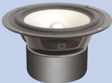
130 mm-Breitband Tief-Mitteltöner mit Alu-Membran, Stahlorb und magnetischer Abschirmung. Linearer Frequenzverlauf bis ca. 6000 Hz. Vorzugsweise einsetzbar im Bassreflex-Gehäuse ab 8 Litern. Sehr gut geeignet für PC oder Heimkinoanwendungen.
